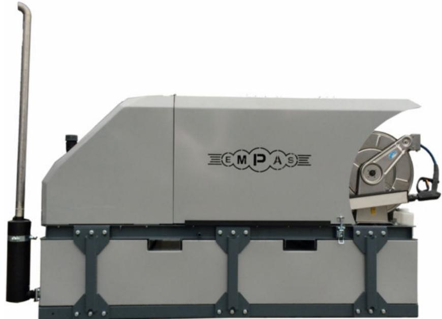
Die Heißwassererzeugungseinheit besteht aus einem Wassertank mit einem Inhalt von 1000 Litern (Basismodell), zwei Hochdruckpumpen, die den beiden Boilern Wasser zuführen, einem Rücklaufwasserkreislauf, der das Wasser bei Nichtverwendung umwälzt sowie zwei Sprühlanzen mit einem
